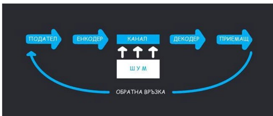
Фигура 1. Модел на Шанън и Уивър с по-късно добавения от Винер компонент „обратна връзка“
