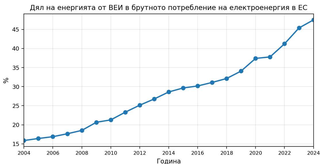
Фигура 2. Дял на енергията от ВЕИ в брутното потребление на електроенергия в ЕС, 2004–2024 г.
